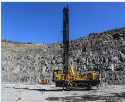
Буровая установка бурит в скалах отверстие. Работает на ней машинист.
